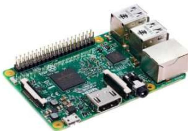
Рис. 2. – Одноплатный компьютер Raspberry Pi 3 B+
