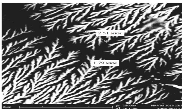
Рис. 2 –Фотография дендритных структур вдоль границ зерен Al, смоченных расплавом Sn-Pb 0.2 ат. %
