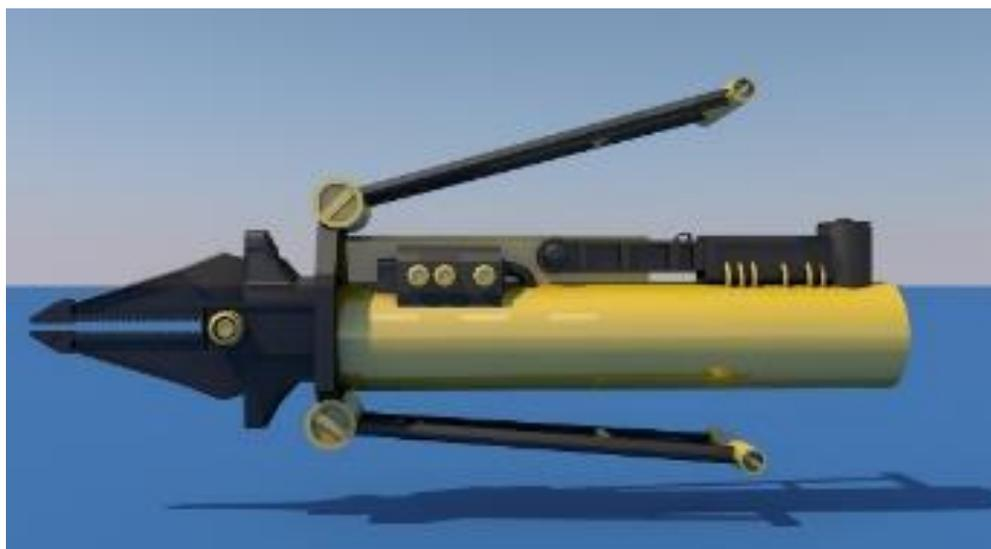
Рис. 7. - 3D-модель комби-ножниц ручных КНР-70 (Авторская разработка)
